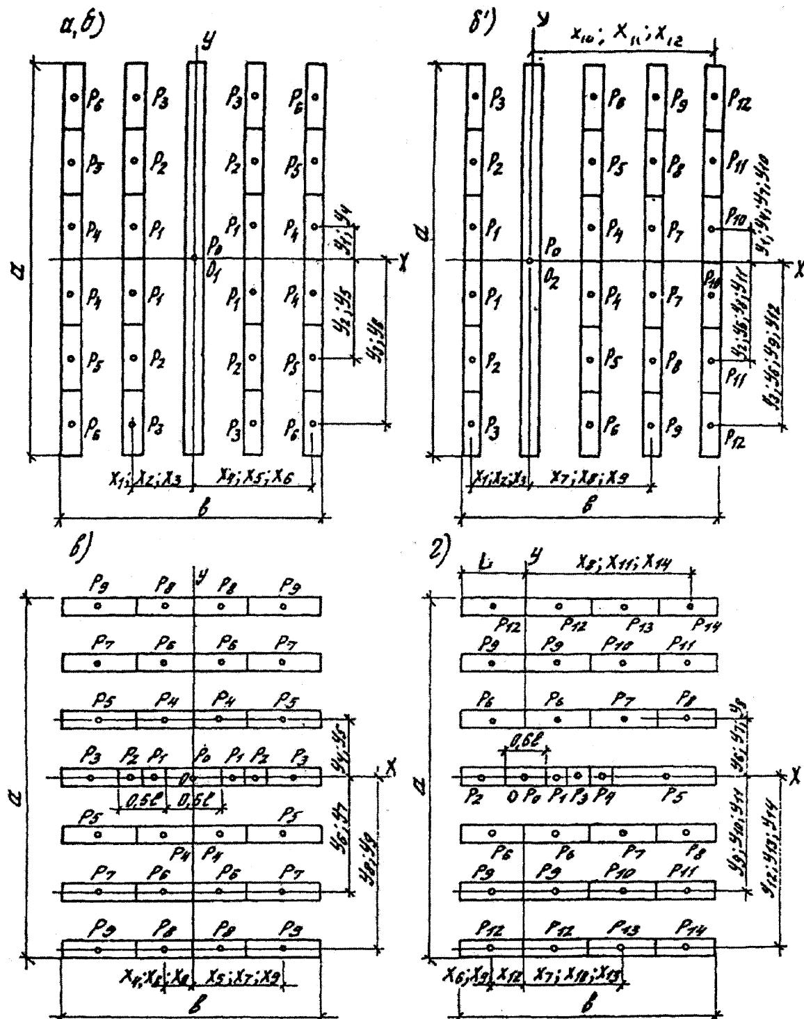
*a*, *b* – нагрузки, равномерно распределенные по длине параллельных следов (от прокладок под тяжелые предметы, от штабелей цилиндрических валов и др.) при  $b \leq 4,4l$ ;  $a > b$ ; *b*, *b'*, *g* – то же, при  $b > 4,4l$ ;  $a > b$
