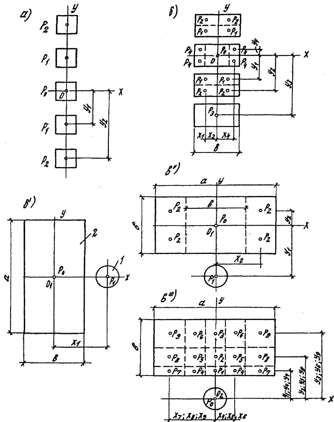
$a$  – нечетное число одинаковых нагрузок, расположенных в один ряд;  $b$  – то же, при четном числе нагрузок  $b \leq 4,4l$ ;  $v$  ( $v'$ ;  $v''$ ;  $v'''$ ) – нагрузка разной величины с различными площадями следов; 1 – след колеса транспортного средства; 2 – след станка, агрегата
